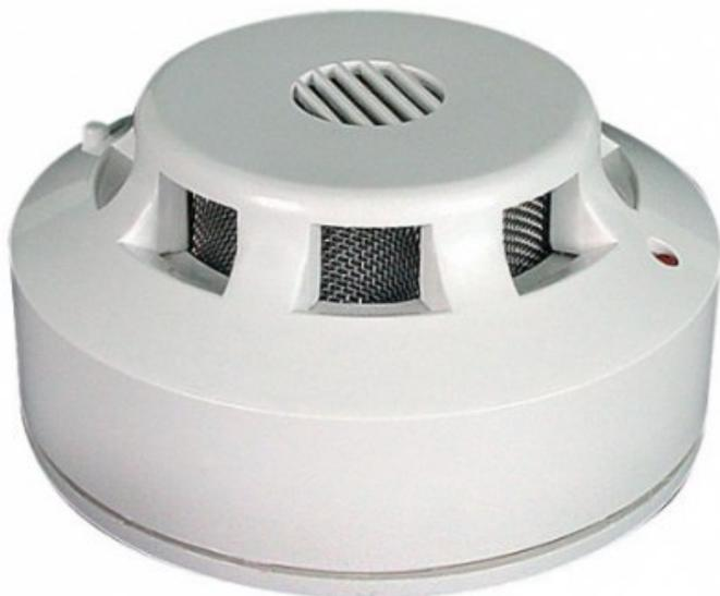
Автономный пожарный извещатель - это пожарный извещатель, реагирующий на определенный уровень концентрации аэрозольных продуктов горения веществ и материалов и, возможно, других факторов пожара, в корпусе которого конструктивно объединены автономный источник питания и все компоненты, необходимые для обнаружения пожара и непосредственного оповещения о нем.
