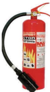
Данный тип предназначен для тушения твердых материалов и веществ, ЛВЖ и ГЖ. Однако не приспособлен для того, чтобы потушить металлы и вещества, для горения которых воздух не нужен (натрий, калий, спирт и другие). Химическая или воздушно-механическая пена, которая находится в огнетушителе, является **проводником электроэнергии**, поэтому не стоит его использовать на воспламенившихся электроустройствах.
